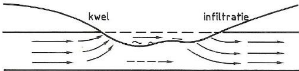
Figuur 4.14: Schematische voorstelling van doorstroommechanisme in een duinvallei
